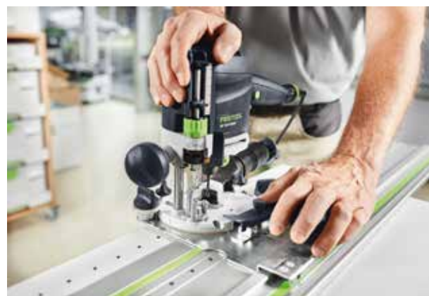
Az OF 1010 vagy OF 1400 maróval és az FS 1400/2-LR 32 vezetősínnel, precíz lyuksorok alakíthatók ki 32 mm-es lyuk-távolsággal.
