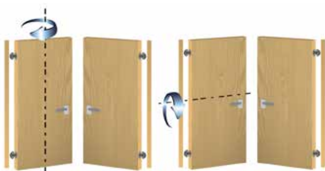
Az INVISACTA pánt megfordítható, ami az ajtót függőlegesen is megfordíthatóvá teszi.
